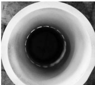
图12 渗透探伤结构
