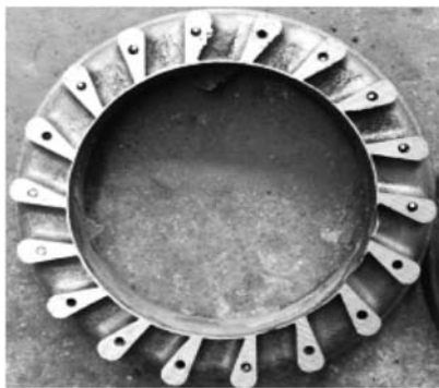
图13 \Phi 8 mm通水孔孔壁均匀
