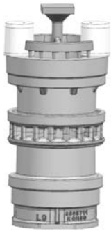
图2 EMD缸套铸造工艺示意图
