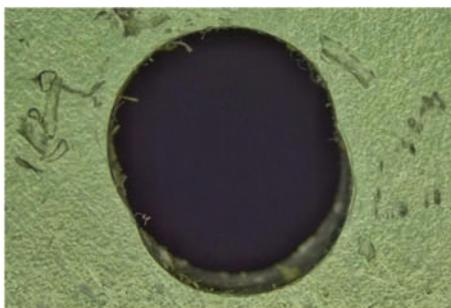
图2 典型长圆孔形貌照片(10号孔)
