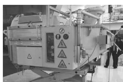
图9 镁合金熔炼压铸防护工艺装备
