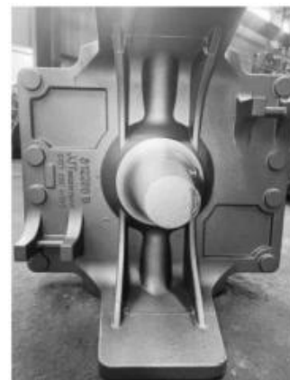
图10 割口抛丸后的毛坯
