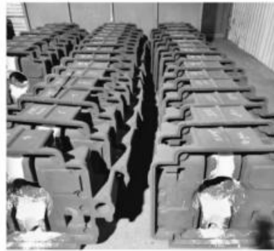
图8 等待组合的覆膜砂壳型
