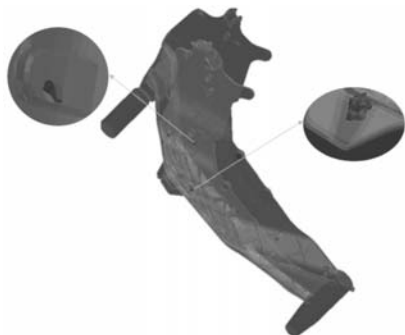
图6 保温措施后缩松、缩孔预测图
