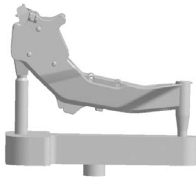
图2 初步浇注系统三维模型
