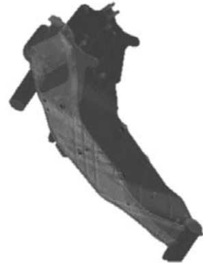
图5 优化浇注系统后缩松缩孔预测图
