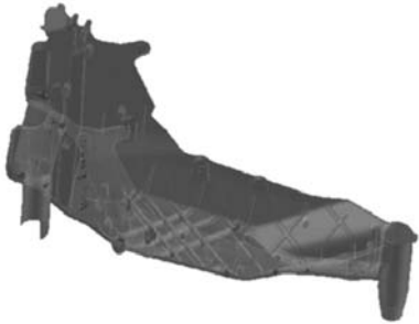
图3 原始浇注系统缩松、缩孔预测图
