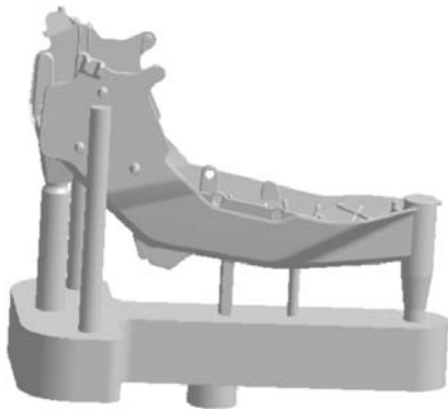
图4 优化后的浇注系统图
