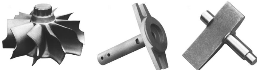
(a) IN713C涡轮增压器叶轮 (b) Haynes 230高温探头 (c) Ninonic 90可调涡轮增压器导向叶片
