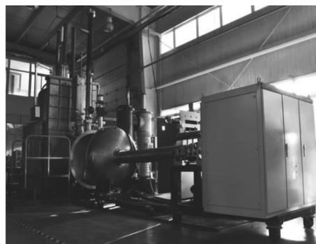
图4 高温合金真空低压铸造炉
