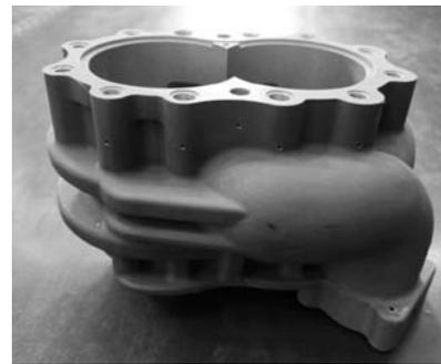
图10 完成加工的铸件
