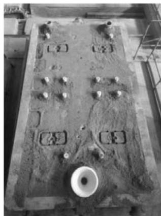
图8 造型排气架起模图
