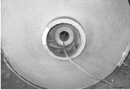
图11 打磨抛丸后的铸件(方案B)
