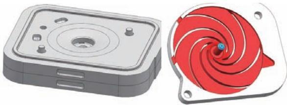
图7 砂型示意图(方案A)
