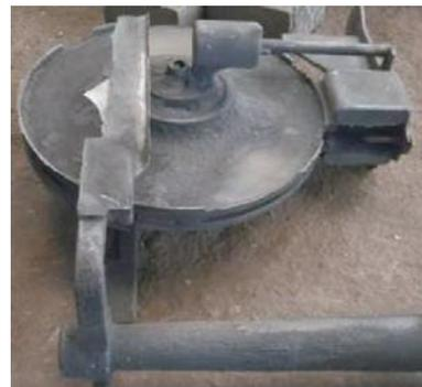
图10 落砂后的铸件(方案B)
