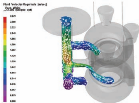
图8 原浇注系统中金属液流速
