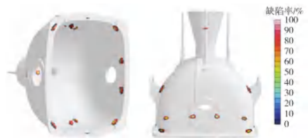
图4 砂型铸造工艺方案铸件缺陷预测
