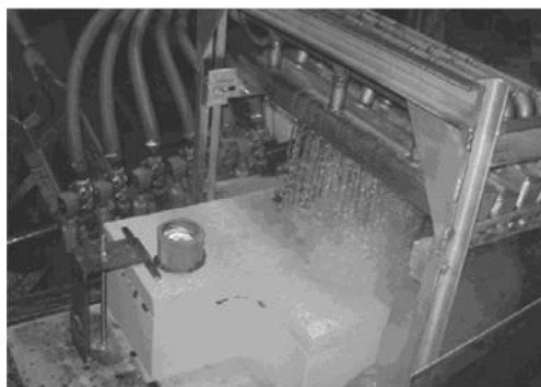
(a) 水幕正在逐层剥离充满金属液的铸型
