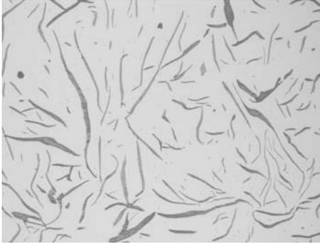
图3 基体石墨微观形貌
