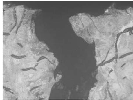
图7 原始裂纹起始处金相组织
