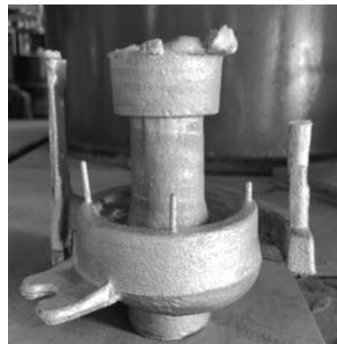
图13 试生产的实际铸件（含铸造工艺部分） Fig. 13 Actual casting for trial production (including casting process parts)
