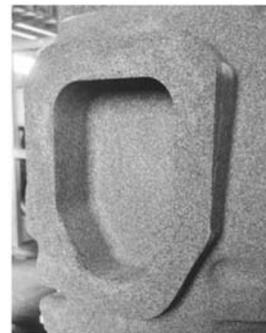
图7 S16R机体铸件窗口砂芯掏空
