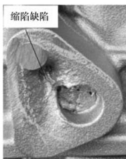
图3 SC10E曲轴箱加油口缩陷
