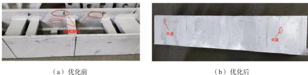
图10 工艺优化前后铸件缺陷位置实物图
