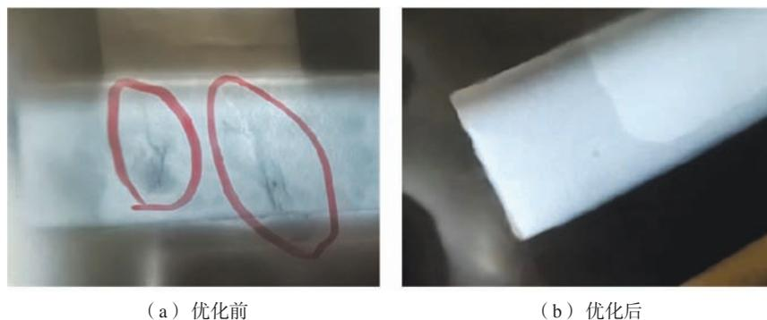
图9 工艺优化前后铸件X射线检测结果
