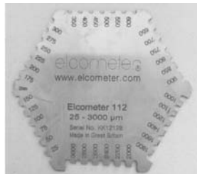
图1 湿膜测厚仪示意图
