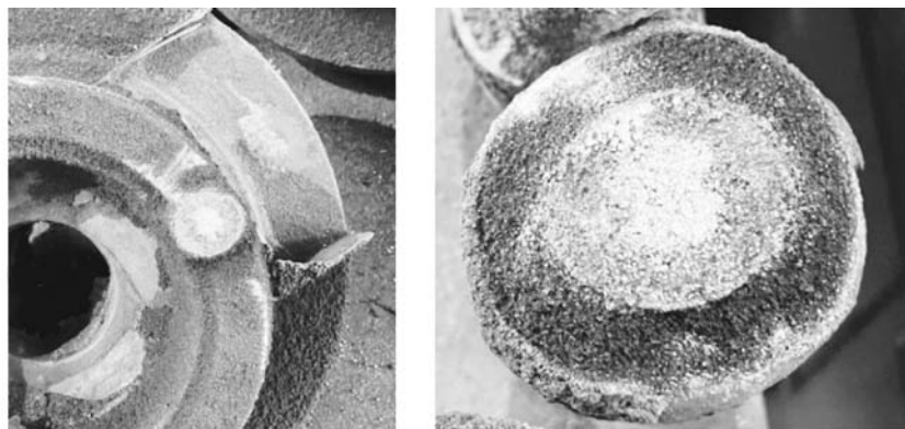
(a) 铸件的冒口断面颜色
