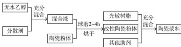
图4 陶瓷浆料制备流程示意图
