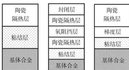
图5 双层、多层和梯度热障涂层结构示意图
