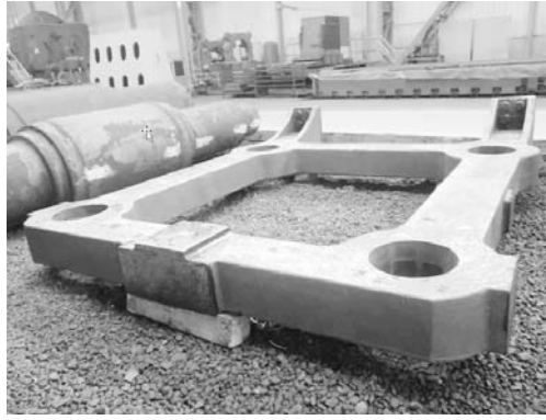
图4 尾架铸件毛坯图片 Fig. 4 Photo of the casting blank
