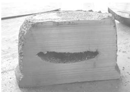
图6 冒口内的二次缩孔
