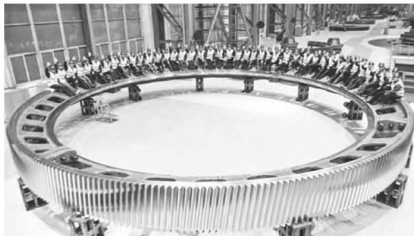
图7 中信重工生产的最大直径半自磨机大齿轮
