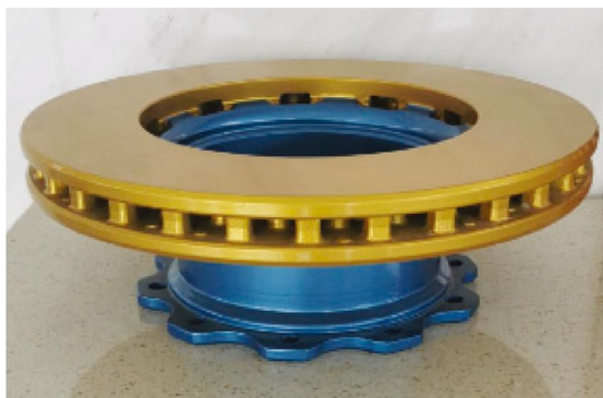
图6 商用车双金属复合材料制动盘
