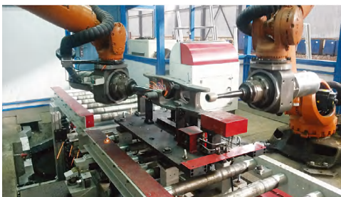
图7 机器人打磨线 Fig. 7 Robot grinding line
