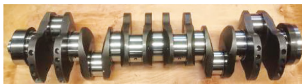
图14 船电6T球铁曲轴（疲劳极限弯矩11500N.M）
