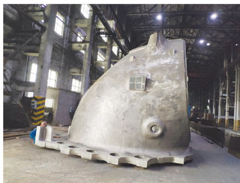
图13 QT600-10材质12兆瓦底座
