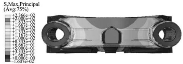
图11 原方案轴承盖应力
