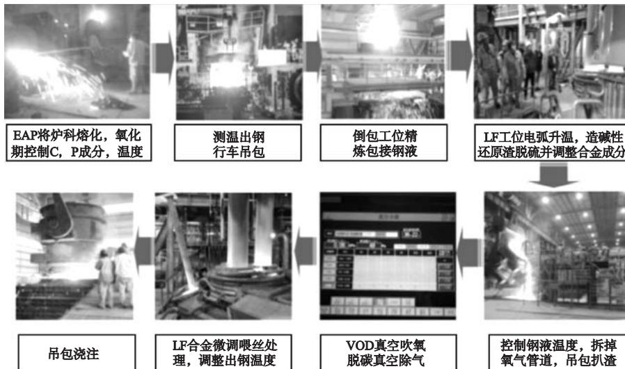
图2 LFV冶炼工艺流程
