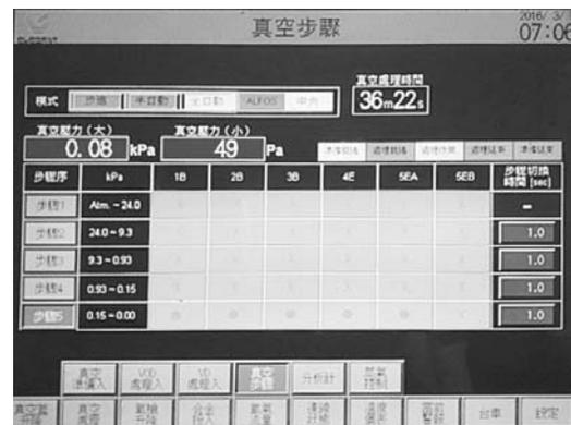
图6 真空步骤控制界面
