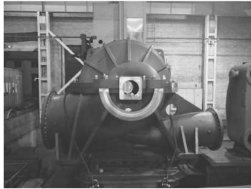
图3 泵体铸件（与泵盖铸件组装在一起）
