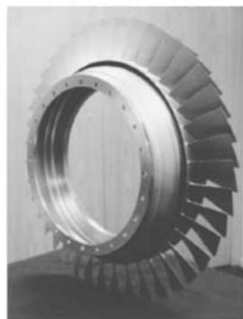
(b) 英国国防部所支持项目研制的EJ200发动机叶环构件
