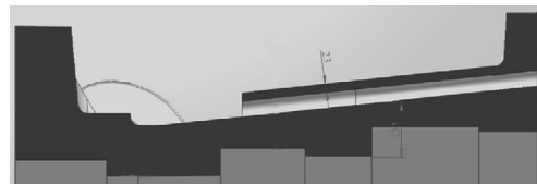
图3 铸孔两侧壁厚示意图
