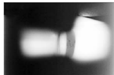
(b) 陶瓷型壳重力顶注
