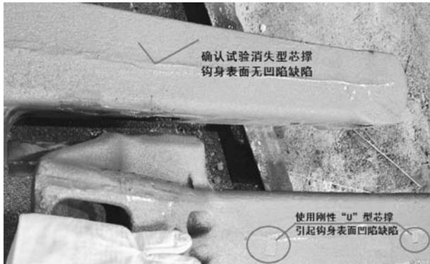
图6 采用消失型芯撑获得钩身表面
