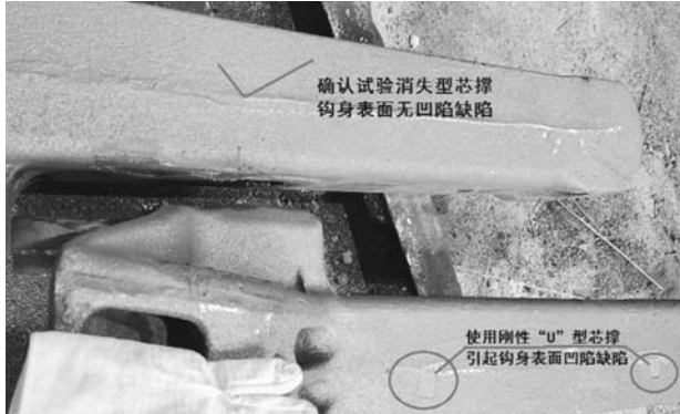
图6 采用消失型芯撑获得钩身表面
