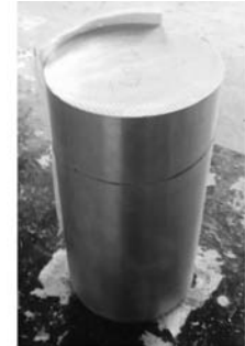
(b) 切冒口及扒皮后的铸锭
