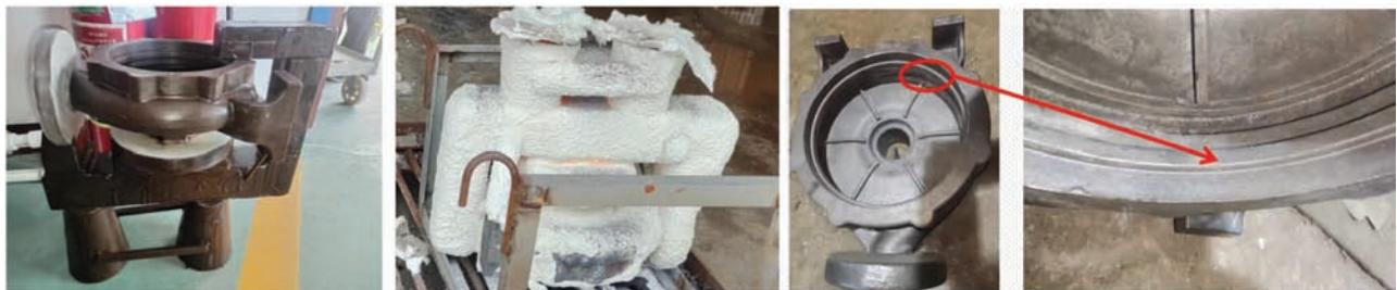
(a) 蜡型组树 (b) 熔炼浇注 (c) 切割清理 (d) 流道位置放大图
