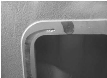
图1 发动机机体气孔缺陷形貌
