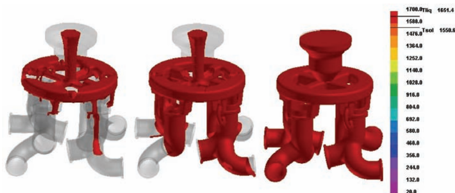
图6 雨淋式浇注系统充型模拟结果
