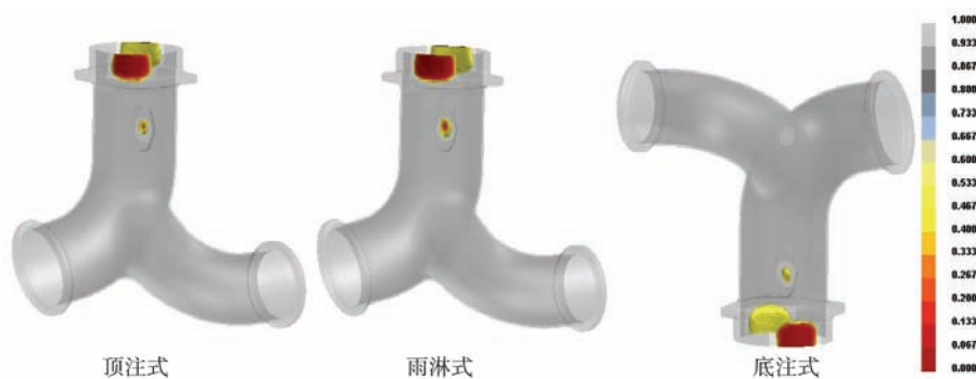
图8 不同浇注系统下铸件孤立液相区分布示意图
