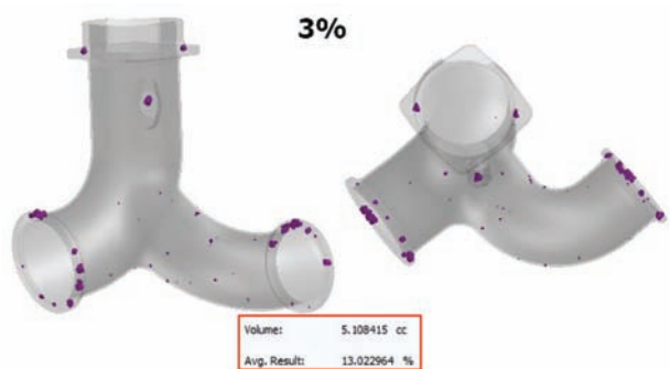
图9 顶注式浇注系统疏松模拟结果
