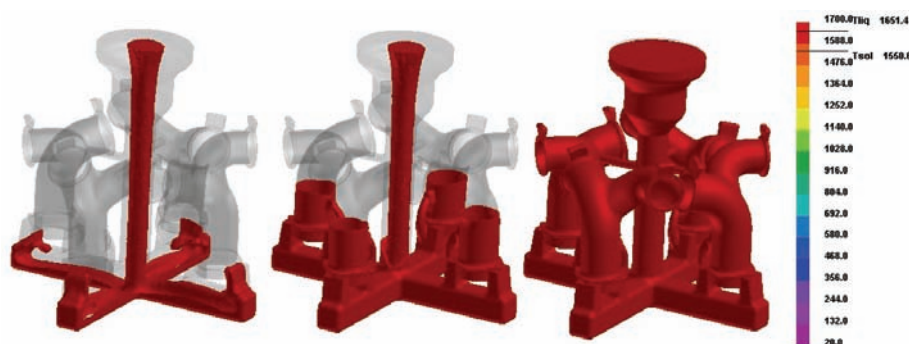
图7 底注式浇注系统充型模拟结果
