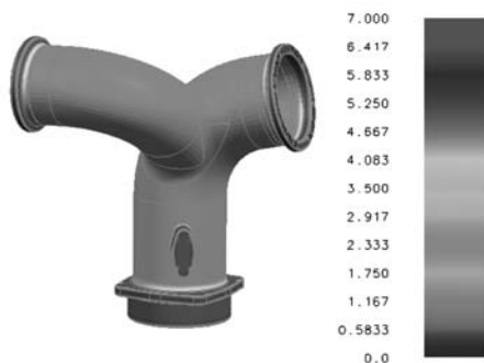
图2 铸件壁厚分布示意图
