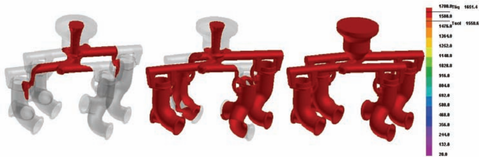
图5 顶注式浇注系统充型模拟结果 Fig. 5 Filling simulation results of top pouring pouring system
