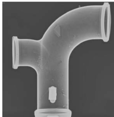
图12 铸件X光示意图
