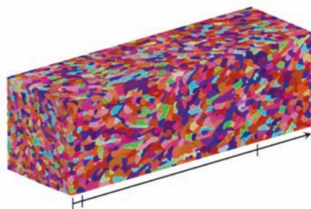
图5 砂型铸造钢锭表层凝固组织数值模拟结果(箭头由钢锭表面指向心部)
