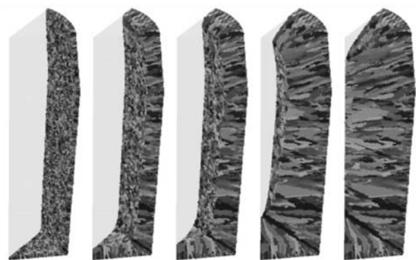
图7 案例01中柱状晶组织形成过程的模拟结果
