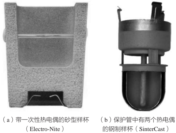
图1 冷却曲线分析用测试样杯示例
