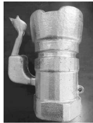
图8 管接头试制铸件
