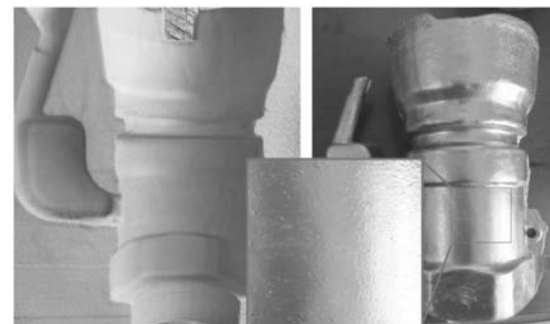
(a) 经打磨处理的砂型 (b) 表面质量改进的铸件
