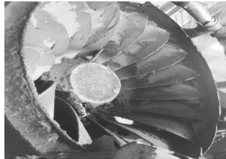
图7 落砂后的铸件
