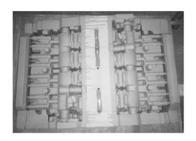
图1 493缸体砂芯(采用38<sup>#</sup>涂料) Fig. 1 493 cylinder core(38<sup>#</sup> coating)
