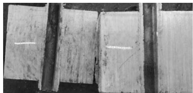
图6 6号预置油道管纵截面剖面
