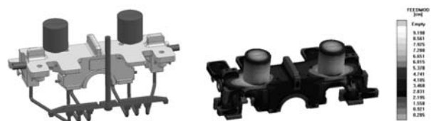
图8 铸件浇冒系统示意及热模数效果图
