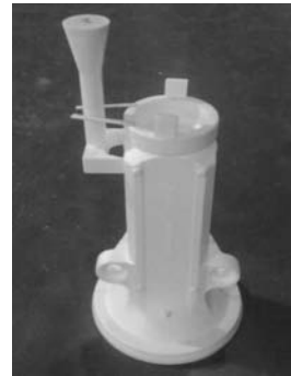
图2 白模组模 Fig. 2 White pattern assembly
