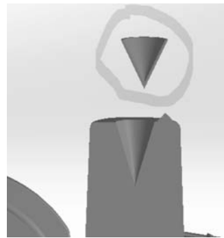
图1 威廉砂芯两瓣镶套示意图
