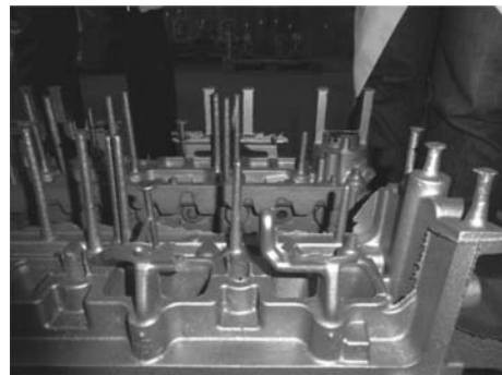
图4 抛丸清理后铸件上表面
