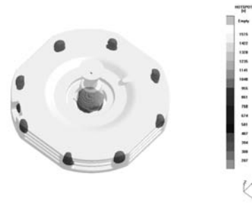
图6 热节显示 Fig. 6 Hot spot display
