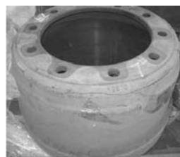
（b）法兰盘与圆鼓面交界处开裂
