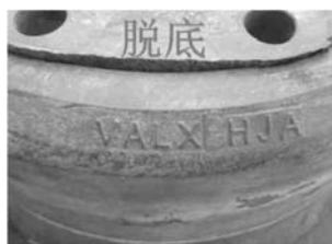
（a）掉底/掉顶/脱底，法兰盘圆角周向开裂或脱落
