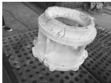
图3 铸件PT时发现的裂纹缺陷图 Fig. 3 PT indications of cracks
