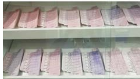
50 MW燃机透平第2级静叶用陶瓷型芯
