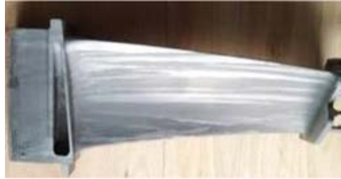
大尺寸定向柱晶叶片（50 MW燃机第3级动叶，高度 > 300 mm）
