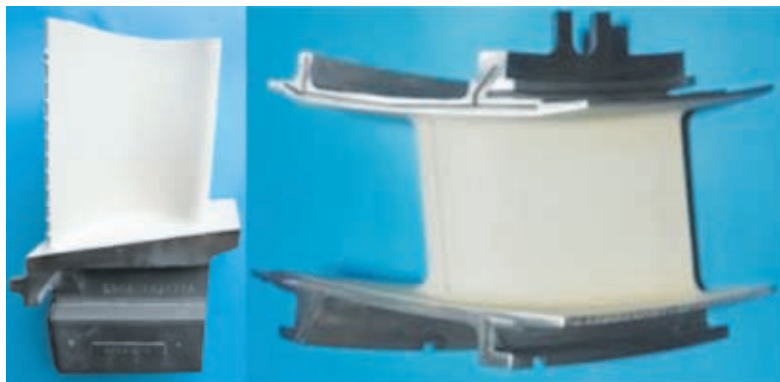
50 MW燃机第1级动叶片、静叶片热障涂层
