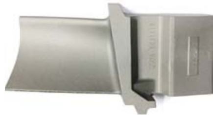
大尺寸单晶叶片（50 MW燃机第2级动叶）
