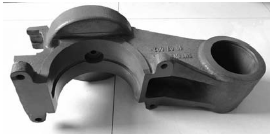
图7 定位转臂铸件实物 Fig. 7 Positioning arm casting
